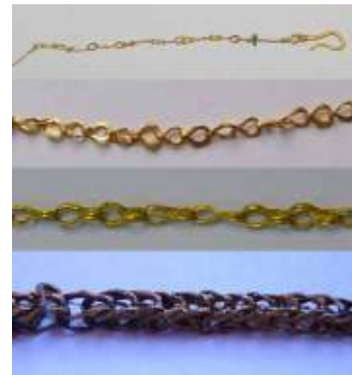
Obr. 56 Využitie drôtikov pre výrobu retiazok. A – články retiazky s očkami na koncoch, B – uzatvorené články, ktoré sa preložia a navliekajú na seba, C – uzatvorené články v tvare osmičiek, D – retiazka vyrobená technikou líščieho chvosta (nem. „Fuchsschwanzkette“).
