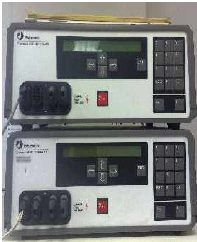
Obr. 6: Dva programovateľné zdroje jednosmerného prúdu MultiDrive XL švédskej firmy Pharmacia LKB Biotechnology
