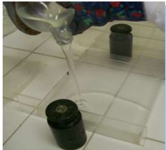
Obr. 13: Vylievanie škrobového gélu do nosiča gélu
