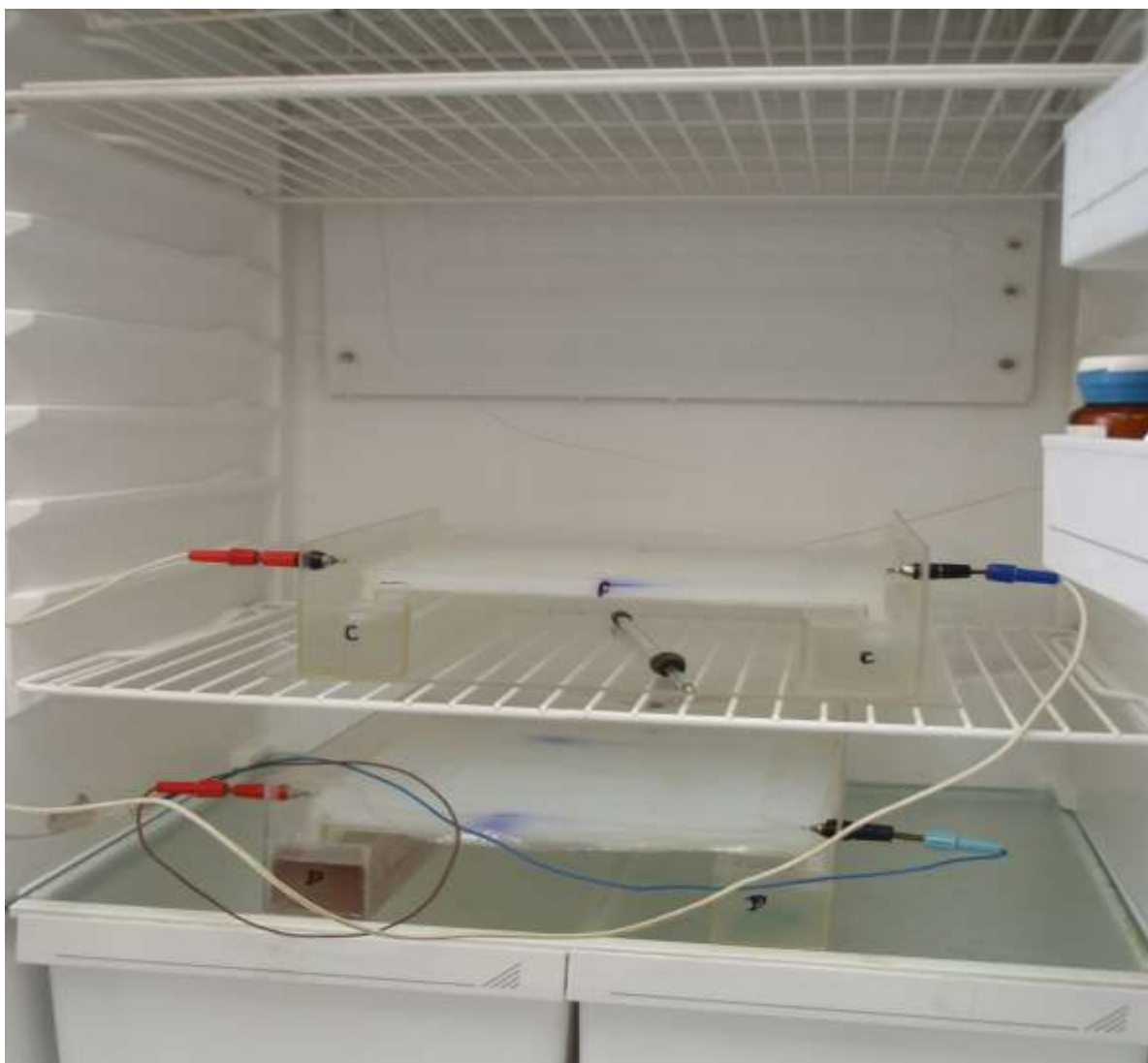
Obr. 15: Zapojenie dvoch elektroforetických aparátúr s elektroforetickou separáciou enzýmov na škrobových géloch s farbičkou (brómfenolová modrá) označujúcou čelo vyvíjania
