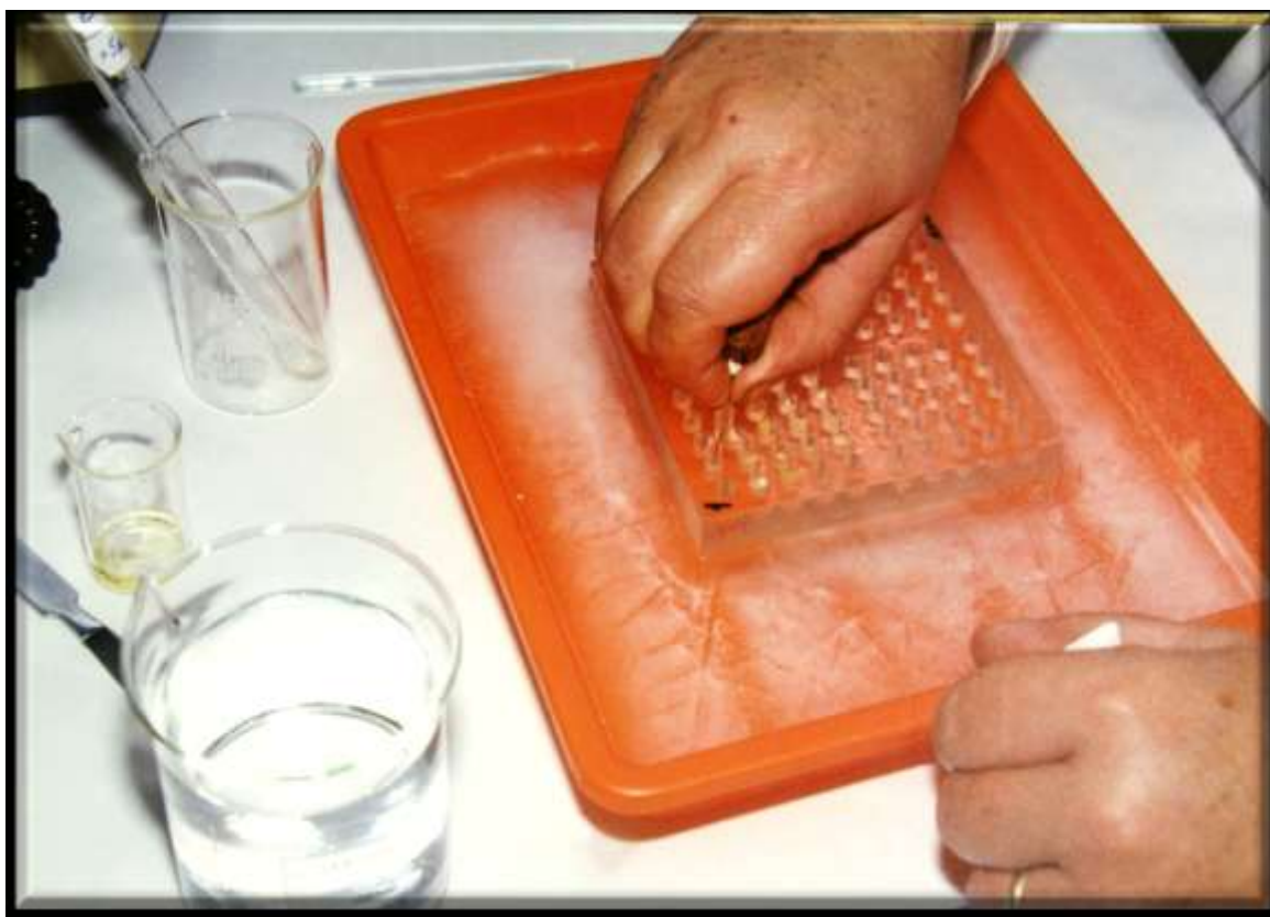
Obr. 9: Ručná homogenizácia vzoriek sklenenou tyčinkou vo fotomiske s ľadom
