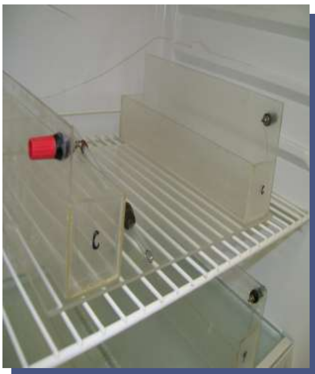
Obr. 4: Dve elektroforetické kyvety (anóda a katóda) umiestnené v chladničke s teplomerom na priebežnú kontrolu teploty počas elektroforézy (vľavo) a detail kladnej elektródy (vpravo)
