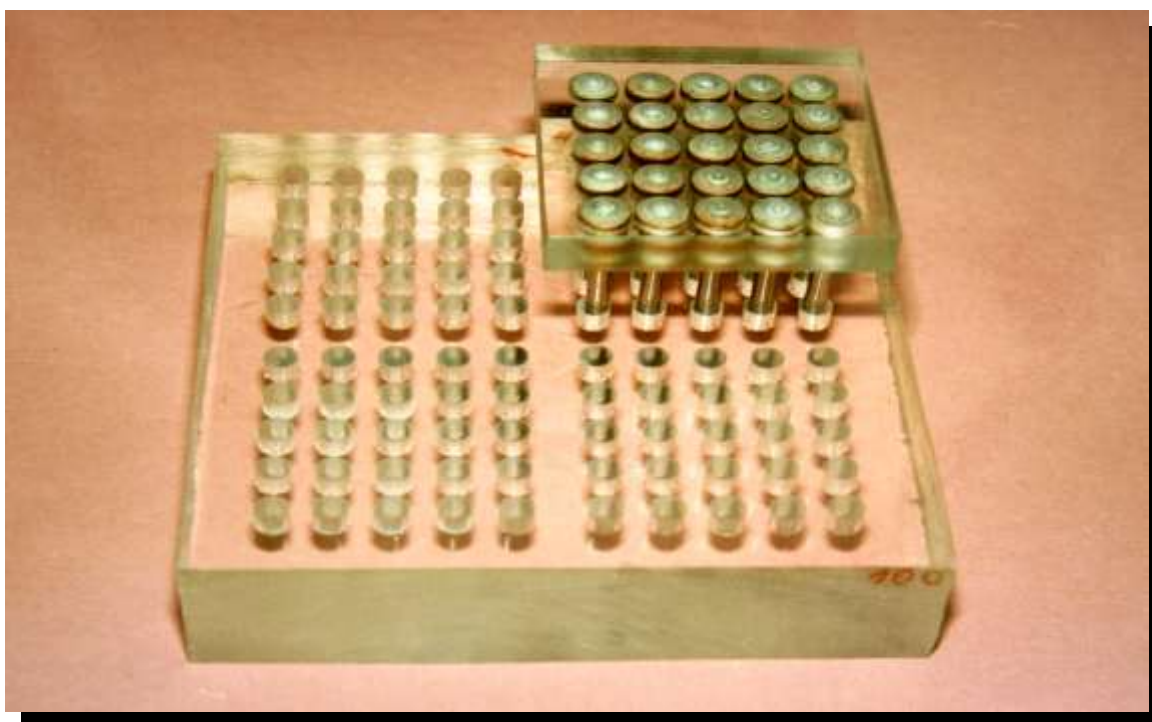
Obr. 11: Akrylová podložka a ručné zariadenie na súčasnú homogenizáciu 25-tich vzoriek
