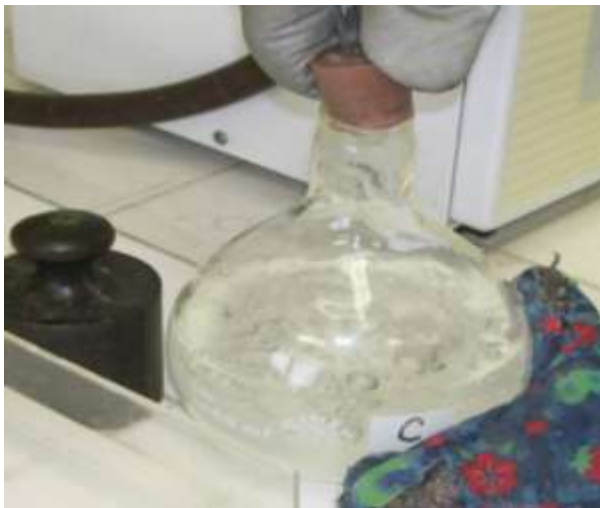
Obr. 12: Odsávanie vzduchu vodnou vývevou zo škrobového gélu vo varnej banke
