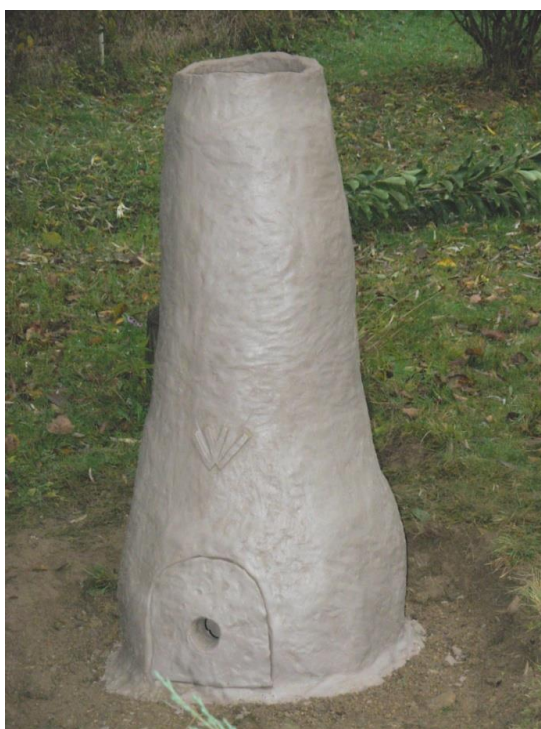
Obr. 9 Rekonštrukcia tzv. slovenskej ťažnej pece na výrobu železa (výška nadzemnej časti cca 120 cm)
